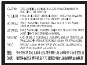
Ova oznaka se nalazi na zaštitnom kućištu lasera u kućištu uređaja.
