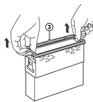
**2 Εισαγάγετε και τα δύο κλειδιά απασφάλισης ② μέχρι να κουμπώσουν και τραβήξτε κάτω το στήριγμα ①, έπειτα τραβήξτε επάνω τη μονάδα για να τη διαχωρίσετε.**
