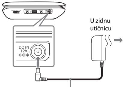
Adapter za naizmeničnu struju (isporučuje se uz uređaj)
