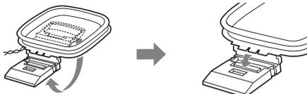
Enrole um cabo de antena à volta da antena e levante o suporte.
