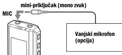
Prilikom spajanja vanjskog mikrofona, ugrađeni mikروفon se automatski isključuje. Kada priključite *plug-in-power* mikروفon, on se automatski napaja iz izvora napajanja IC-rekordera.
