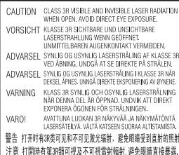
Ovaj je uređaj klasificiran kao laserski proizvod klase 3R. Kada se otvoru zaštitno kućište lasera, emitira se vidljivo i nevidljivo lasersko zračenje i zato obavezno pazite da oči ne izlažete direktno laserskim zrakama.
