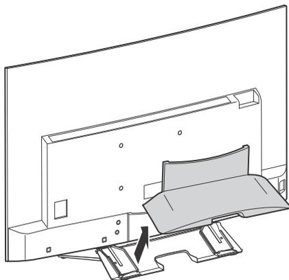
**2** Извлеките винты из задней панели телевизора.
