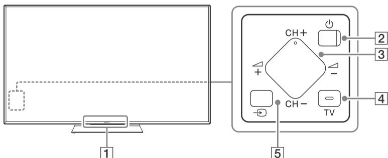
**1 Датчик пульта дистанционного управления\*1 / светочувствительный датчик\*1 / светодиодный индикатор**
