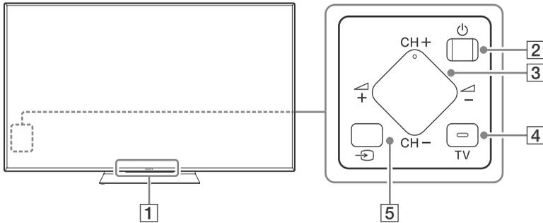
**1 Датчик пристрою дистанційного керування\*1 / датчик світла\*1 / індикатор підсвічування**
