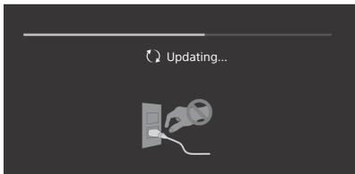
Не отсоединяйте кабель питания переменного тока во время обновления программного обеспечения. В противном случае обновление программного обеспечения может не завершиться, что может стать причиной некорректной работы программного обеспечения. Обновление программного обеспечения может занять до 30 минут. Если не требуется автоматически обновлять программное обеспечение, нажмите кнопку **HOME** и выберите [Справка] → [Обновление системы] → [Автоматическая загрузка ПО] → [Выкл.].
