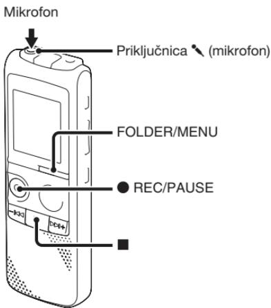
**1** Spojite vanjski mikrofon u priključnicu (mikrofon) dok je IC rekorder u stop modu.
