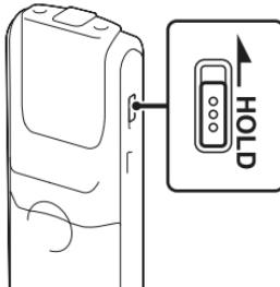
Pomaknite preklopku HOLD u suprotnom smjeru od strelice. IC rekorder se uključuje i treperi "ACCESS".
