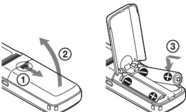
Ako se pokrov baterijskog pretinca slučajno odspoji, pričvrstite ga na način prikazan slikom.
