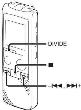
Poruku možete podijeliti tijekom reprodukcije tako da je podijeljena na dva dijela i svakom dijelu se dodjeljuje novi broj. Dijeljenjem poruke možete na vrlo jednostavan način pronaći željeni dio poruke koji želite reproducirati nakon dužeg snimanja, primjerice sastanka. Poruke je moguće dijeliti dok ukupan broj poruka u mapi ne dosegne broj 99.
