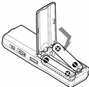
Ukoliko se pokrov pretinca za baterije slučajno odvoji, ponovno ga postavite na način koji je prikazan na slici.
