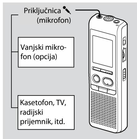
**1** Spojite *plug-in-power* mikrofon ili drugu opremu u priključnicu (mikrofon).
