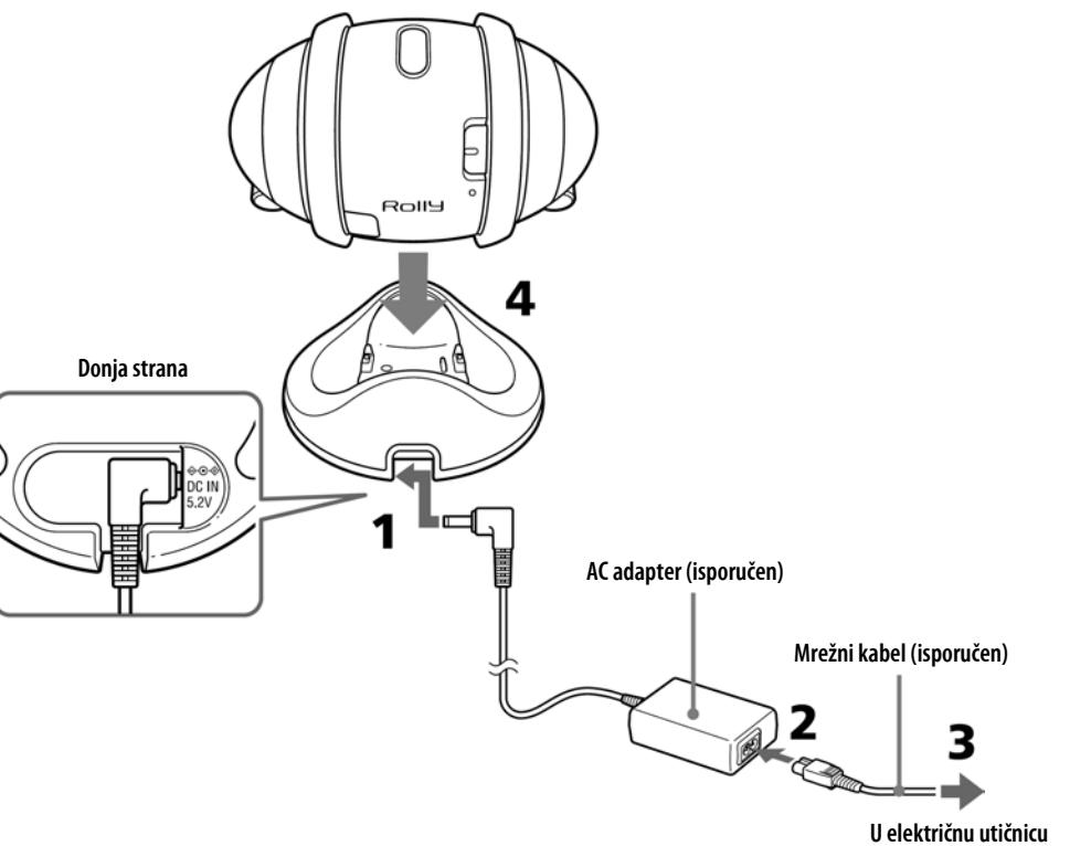
1 Spojite AC adapter u priključnicu DC IN 5.2V na punjaču.
