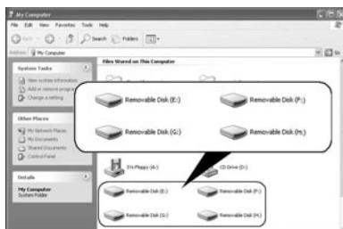
Обозначенные буквами значки съемных дисков, соответствующие слотам для карт памяти CompactFlash/Microdrive, SmartMedia/xD-Picture Card, MultiMediaCard/SD Memory Card и “Memory Stick”, приводятся в алфавитном порядке. Например, если до подсоединения устройства считывания/записи для компьютера отображались диски А:, С: и D:, то после подсоединения устройства считывания/записи дискам будут назначены следующие буквы.
