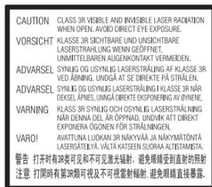
A unidade de leitura deste aparelho está classificada como equipamento CLASS 3R LASER. É emitida radiação laser visível e invisível quando a cobertura de proteção do laser está aberta, por isso, evite a exposição direta da vista.
