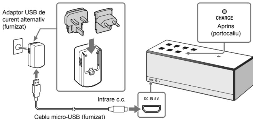
Încărcarea începe când unitatea este conectată la o priză de perete prin intermediul adaptorului USB de c.a., iar indicatorul ÎNCĂRCARE (Charge) se aprinde, fiind de culoare portocalie. Încărcarea acumulatorului durează aproximativ 5 ore, după care indicatorul luminos se stinge.
