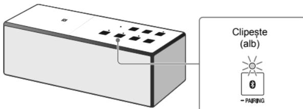
Când folosiți funcția BLUETOOTH pentru prima dată, și când doar atingeți butonul **∅** (BLUETOOTH) — PAIRING, indicatorul **∅** BLUETOOTH va începe să clipească des, fiind de culoare albă, iar unitatea intră în modul de punere în legătură automată.
