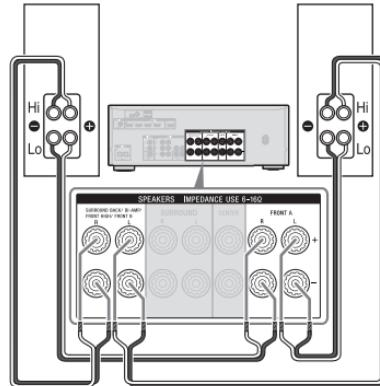
Соедините разъем на стороне Lo (или Hi) фронтальных динамиков с терминалами SPEAKERS FRONT A и соедините разъемы на стороне Hi (или Lo) фронтальных динамиков с терминалами SPEAKERS SURROUND BACK/BI-AMP/FRONT HIGH/FRONT B. Убедитесь, что металлические фитинги Hi/Lo, подключенные динамики, удалены из динамиков, чтобы предотвратить повреждение ресивера. После настройки подключения двунаправленного усилителя задайте для параметра "SB Assign" значение "Bi-Amp" в меню настроек динамиков (стр. 64).
