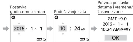
Pritisnite dugme REC/ENTER na ekranu za podešavanje datuma i vremena/časovne zone da biste potvrdili željenu stavku, a zatim će se prikazati ekran režima mirovanja za Wi-Fi.
