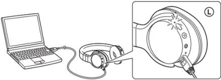
Kad šī ierīce ir pieslēgta pie datora, sākas uzlādēšana un izgaismojas indikators (sarkans). Uzlādēšana tiek pabeigta maksimāli pēc 2,5 stundām, un automātiski nodziest indikators (sarkans).
