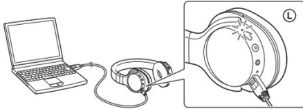
Kui see seade on arvutile ühendatud, algab laadimine ja sūtītt indikaator (punane). Laadimine lõpetatakse maksimaalselt 2,5 tunni pārast ja laadimise indikaator (punane) kustub.
