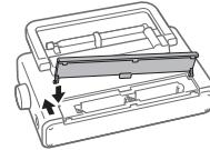
Ievietojiet vāciņa labā āķīša izcilni labajā atverē, pēc tam novietojiet kreisā āķīša izcilni nodalījuma malā un lēni bidiet to iekšā, līdz tas ir atrodas kreisajā atverē.
