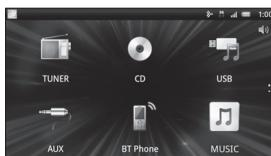
Pro výběr jiného zdroje nebo aplikace stiskněte tlačítko SRC (zdroj) a pak otočením otočného ovladače vyberte požadovaný zdroj nebo aplikaci.
