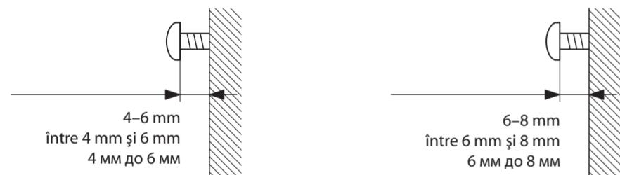
A keskeny magas hangsugárzók esetén (csak a BDV-E690/E490 modellek esetén)
