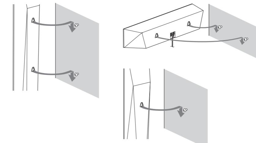
**A szatellit-hangsugárzók felszerelése az állványra (csak a BDV-N8100W/N7100W/N7100WL esetén)**
