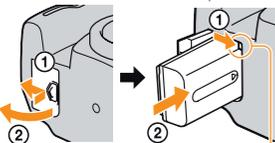
Zasuňte akumulátor na doraz, pričom jeho špičkou zároveň zatlačte na zaisťovaciu páčku akumulátora.
