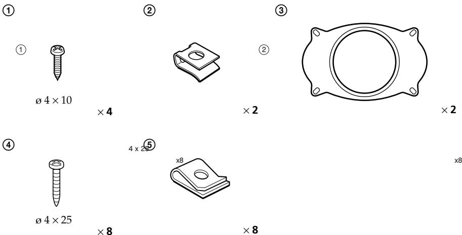
Числата в списъка на комплекта са свързани с тези в упътването за употреба. Използването на тези части за инсталација или създаване на друг вид свързване зависи от формата на автомобила.
