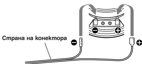
В зависимост от модела на автомобила, използвайте специален конектор (не е приложен в комплекта). Вижте монтажния пример за повече подробности.
