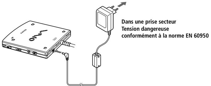
Cordon de l'adaptateur secteur (tension de sécurité extra-basse, conformément à la norme EN 60950)
