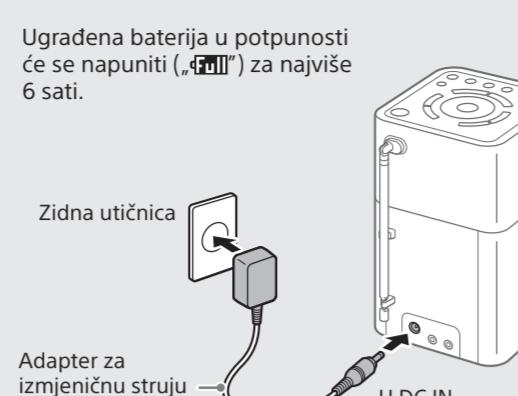
Prije prve upotrebe jedinice obavezno priključite jedinicu u zidnu utičnicu pomoću adaptora za izmjeničnu struju (isporučen). U protivnom se jedinica neće uključiti.
