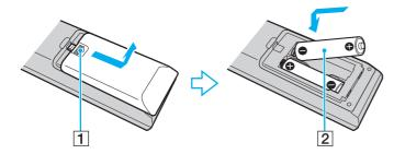
Wenn die Fernbedienung nicht ordnungsgemäß funktioniert, müssen Sie möglicherweise die Batterien austauschen. Wenn die Fernbedienung längere Zeit nicht benutzt wird, nehmen Sie die Batterien heraus, um einen möglichen Schaden durch Auslaufen der Batterien zu vermeiden.
