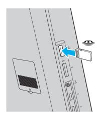
Bevor Sie ein Memory Stick Micro (M2)-Medium verwenden, müssen Sie das Medium in einen M2-Duo-Adapter einsetzen. Falls Sie das Speichermedium ohne den Adapter direkt in den Memory Stick Duo-Steckplatz einsetzen, können Sie es unter Umständen nicht wieder aus dem Steckplatz entnehmen.
