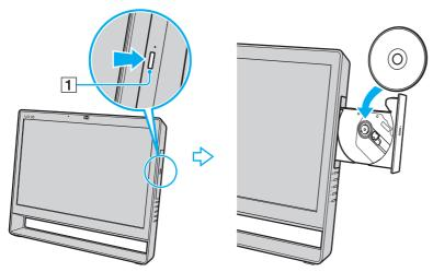
Üben Sie keinen Druck auf die Laufwerksschublade aus. Halten Sie unbedingt die Rückseite der Schublade fest, wenn Sie Discs einlegen oder herausnehmen.
