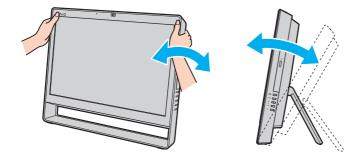
Üben Sie beim Einstellen des Neigungswinkels keinen übermäßigen Druck auf den Computer aus. Andernfalls besteht das Risiko eines mechanischen Schadens.
