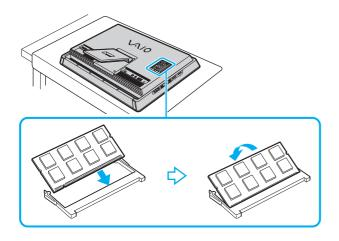
Berühren Sie außer dem Speichermodul keine anderen Komponenten der Hauptplatine.
