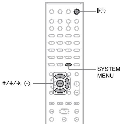
Po zapojení sietovej šnúry systému do elektrickej zásuvky sa na displeji zobráží predvádzacie zobrazenie. Ak stlačíte **I/O** na DO, predvádzanie sa vypne.
