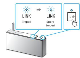
Indikator I/⏻ (uključivanje/stanje mirovanja) će početi da svetli zelenom bojom. Predite na sledeći korak kada indikator LINK počne da treperi sporo (jednom u 3 sekunde). Sporo treperenje počinje za oko 2 minuta.
