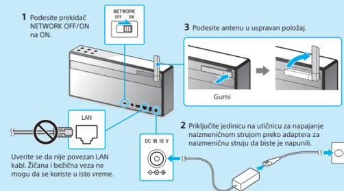
Izaberite metod Wi-Fi veze u zavisnosti od uređaja, a zatim predite na odeljak „1 Povezivanje jedinice na Wi-Fi mrežu“ u nastavku.
