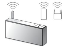
Povežite jedinicu i iPhone/iPad/iPod touch uređaj na isti SSID rutera. Pogledajte sledeću stranicu gde se nalaze uputstva za povezivanje jedinice na Wi-Fi mrežu i proverite da li indikator LINK na jedinici svetli narandžastom bojom.
