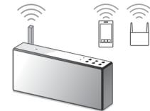
Povežite jedinicu i Xperia uređaj na isti SSID rutera. Pogledajte sledeću stranicu gde se nalaze uputstva za povezivanje jedinice na Wi-Fi mrežu i proverite da li indikator LINK na jedinici svetli narandžastom bojom.
