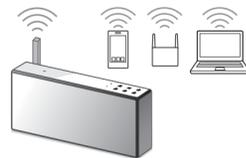
Povežite jedinicu i sve uređaje na isti SSID rutera. Pogledajte sledeću stranicu gde se nalaze uputstva za povezivanje jedinice na Wi-Fi mrežu i proverite da li indikator LINK na jedinici svetli narandžastom bojom.
