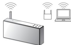
Povežite jedinicu i PC računar na isti SSID rutera. Pogledajte sledeću stranicu gde se nalaze uputstva za povezivanje jedinice na Wi-Fi mrežu i proverite da li indikator LINK na jedinici svetli narandžastom bojom.
