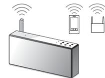
Povežite jedinicu i pametni telefon/iPhone uređaj na isti SSID rutera. Pogledajte sledeću stranicu gde se nalaze uputstva za povezivanje jedinice na Wi-Fi mrežu i proverite da li indikator LINK na jedinici svetli narandžastom bojom.
