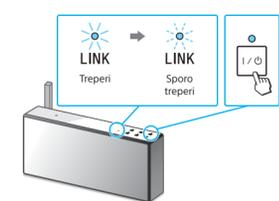
Indikator I/⏻ (uključivanje/stanje mirovanja) će početi da svetli zelenom bojom. Predite na sledeći korak kada indikator LINK počne da treperi sporo (jednom u 3 sekunde). Sporo treperenje počinje za oko 2 minuta.
