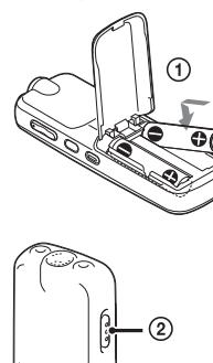
② Pomerite i podignite poklopac odeljka za bateriju, zatim postavite baterije pazeći na pravilan smer polariteti.
