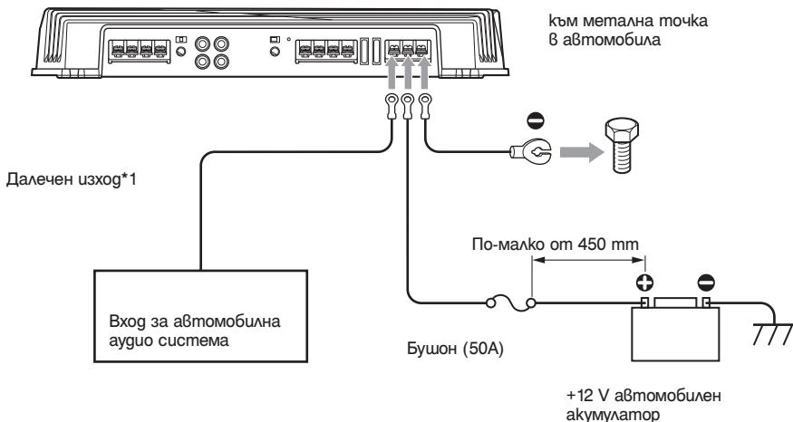
\*1 Ако сте с оригиналната аудио система или друга система без изход за отделен усилвател, свържете входния терминал (REMOTE) към захранването на аксесоара.
