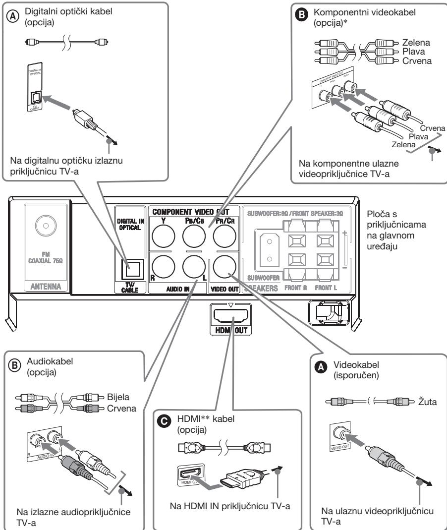
\* Ako vaš TV prihvata signale progressive formata, primijenite ovo povezivanje i podešite izlazni signal sustava na progressive format.
