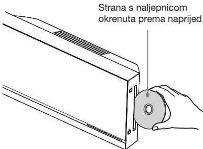
Uređaj automatski uvlači disk i zatim automatski započinje reprodukciju.
