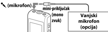
Prilikom spajanja vanjskog mikrofona, ugrađeni mikروفon se automatski isključuje. Kada priključite *plug-in-power* mikروفon, on se automatski napaja iz izvora napajanja IC rekordera.
