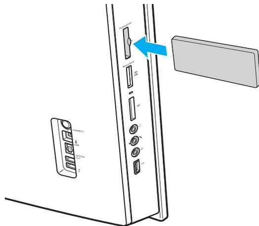
**!** Insérez le capot de protection de l'emplacement ExpressCard afin de protéger l'emplacement de la poussière lorsque vous n'utilisez pas de module ExpressCard. Avant de déplacer votre ordinateur, veillez à bien insérer le capot de protection de l'emplacement ExpressCard en place.
