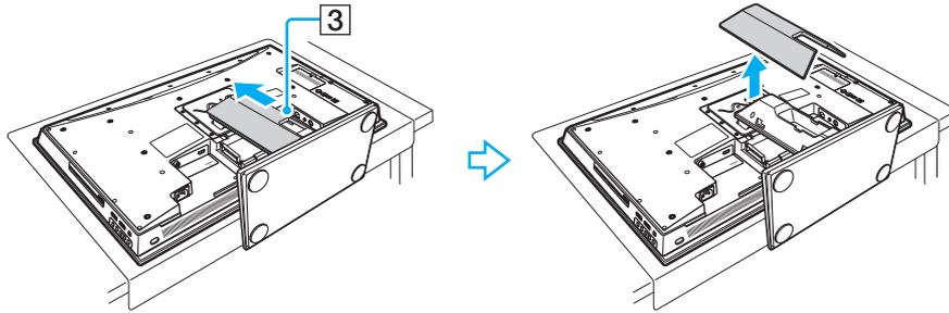
Pour remettre en place les caches du panneau arrière et du support
