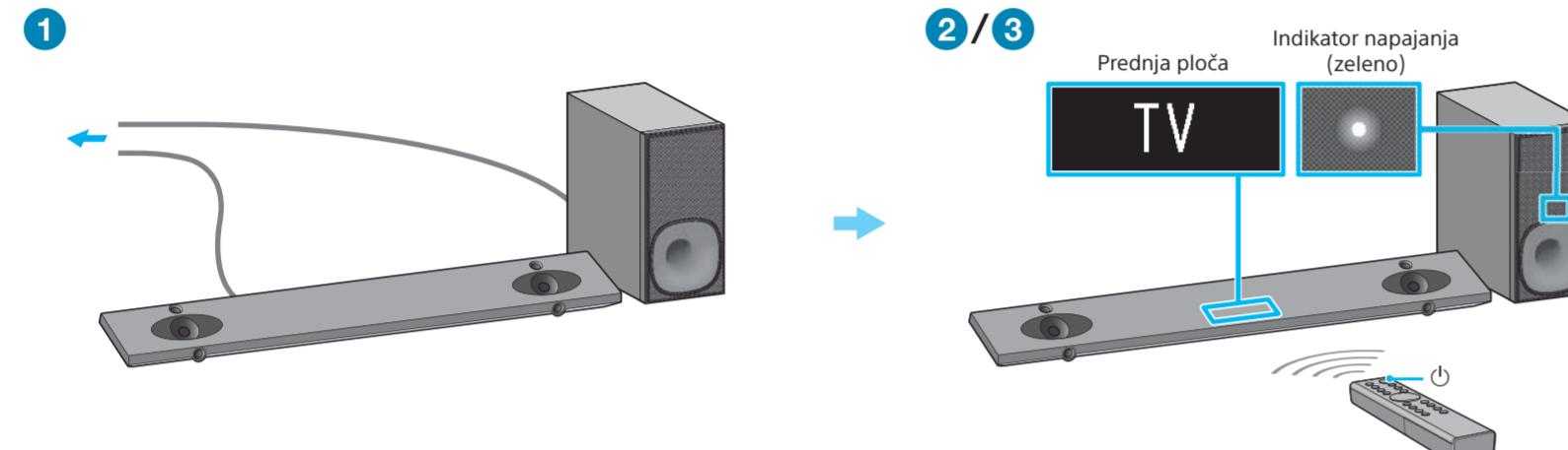
**1** Povežite kabele za napajanje izmjeničnom strujom (glavni vodič) tankog zvučnika i subwoofera.
