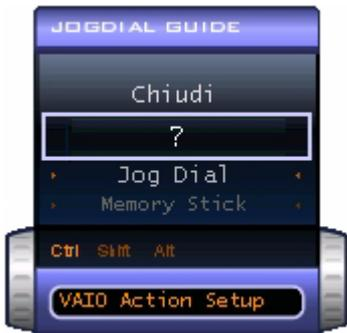
La finestra di **Jog Dial™** passa alla modalità Guida quando si avvia un'applicazione e viene visualizzata la relativa finestra. A seconda del tipo di applicazione, la finestra di Jog Dial™ mostra diversi comandi che è possibile selezionare o eseguire ruotando o premendo Jog Dial™.
