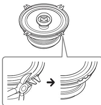
Po odstranění montážních západek lze reproduktor namontovat téměř do každého typu automobilu.
