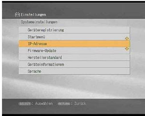
f) Wählen Sie **IP-Adresse automatisch beziehen (ohne Router)**. Bestätigen Sie mit **OK**, indem Sie die Taste **SELECT** drücken.
