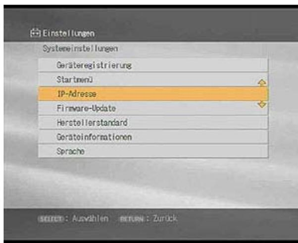
g) Wählen Sie **IP-Adresse automatisch beziehen (ohne Router)**. Bestätigen Sie mit **OK**, indem Sie die Taste **SELECT** drücken.
