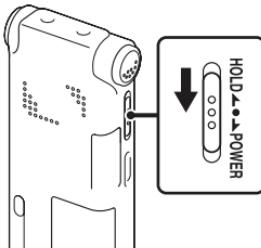
Držite preklopku HOLD/POWER u smjeru "POWER" dulje od jedne sekunde. IC rekorder se uključuje i prikazuje se animacija "Accessing...".
