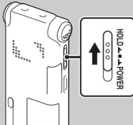
Pomaknite preklopku HOLD/POWER u smjeru "HOLD". Tijekom približno 3 sekunde prikazivat će se "HOLD", što označava da je rukovanje tipkama zaprijećeno.
