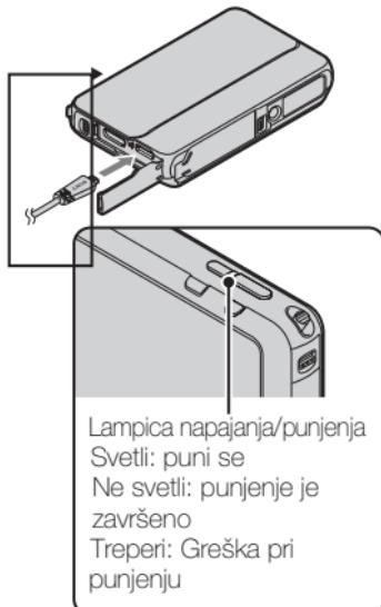
**1** Otvorite poklopac priključka i priključite fotoaparat i AC adapter (isporučeno) koristeći USB kabl za višenamenski terminal (isporučeno).
