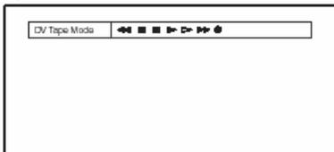
Dacă se afișează „DV” sau „DV Camera Mode” în loc de „DV Tape Mode”, verificați dacă este corect conectată camera video și dacă aceasta este pusă în funcțiune, iar dacă modul ei de funcționare este setat pentru dubbing.
