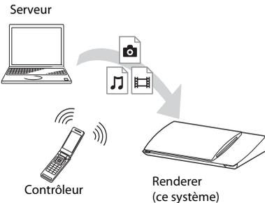
Commandez ce système à l'aide d'un contrôleur DLNA.
