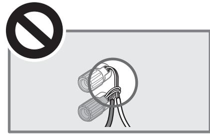
Os cabos dos altifalantes estão em contacto um com o outro devido à remoção excessiva de isolamento.
