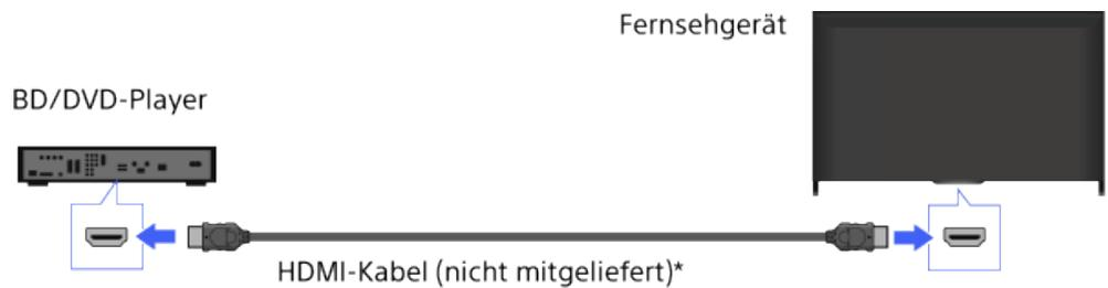
\* Verwenden Sie unbedingt ein zugelassenes HIGH SPEED HDMI-Kabel mit dem HDMI-Logo.
