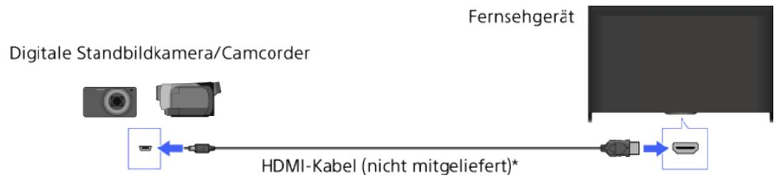
\* Verwenden Sie unbedingt ein zugelassenes HIGH SPEED HDMI-Kabel mit dem HDMI-Logo.
