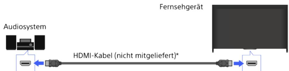
\* Verwenden Sie unbedingt ein zugelassenes HIGH SPEED HDMI-Kabel mit dem HDMI-Logo.
