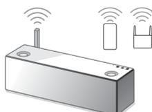
Pripojte systém a zariadenie iPhone, iPad alebo iPod touch k rovnakému identifikátoru SSID smerovača. Na druhej strane si prečítajte informácie o pripojení systému k sieti Wi-Fi a uistite sa, že indikátor LINK na systéme svieti na oranžovo.
