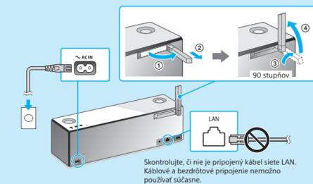
Skontrolujte, či nie je pripojený kábel siete LAN. Kábelové a bezdrôtové pripojenie nemožno používať súčasne.
