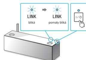
Indikátor I/O (zapnuté/pohotovostný režim) sa rozsvieti na zeleno. Keď indikátor LINK začne pomaly blikať (raz za 3 sekundy), prejdite k ďalšiemu kroku. Indikátor začne pomaly blikať približne za 2 minúty.
