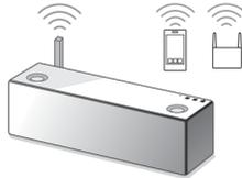
Pripojte systém a smartfón alebo zariadenie iPhone k rovnakému identifikátoru SSID smerovača. Na druhej strane si prečítajte informácie o pripojení systému k sieti Wi-Fi a uistite sa, že indikátor LINK na systéme svieti na oranžovo.
