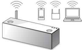
Pripojte systém a všetky zariadenia k rovnakému identifikátoru SSID smerovača. Na druhej strane si prečítajte informácie o pripojení systému k sieti Wi-Fi a uistite sa, že indikátor LINK na systéme svieti na oranžovo.
