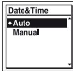
Kad odaberete "Auto", sat se automatski podešava u skladu sa satom u računalu kod spajanja IC rekordera s računalom na kojem je pokrenut isporučeni softver Sound Organizer.
