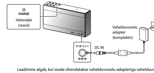
Laadimine algab, kui seade ühendatakse vahelduvvoolu adapteriga vahelduvvoolu kontakti ning CHARGE indikaator süttib oranžilt. Laadimine lõppib umbes nelja tunni pärast ja indikaator kustub.
