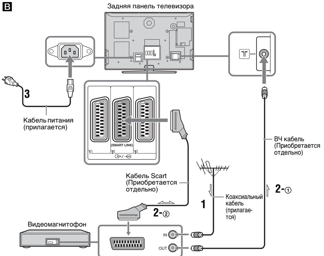
**1** Подсоедините антенну с помощью прилагаемого коаксиального кабеля.
