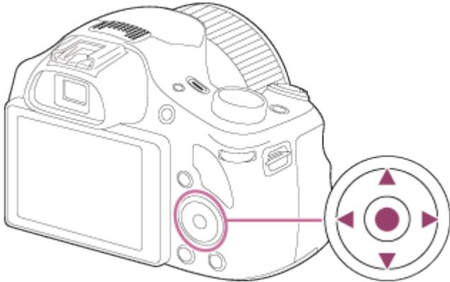
È possibile spostare il cursore di selezione premendo il lato superiore/inferiore/destro/sinistro del tasto di controllo. La selezione è determinata quando si preme ● al centro del tasto di controllo.
