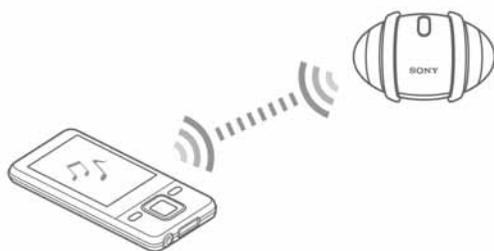
Bluetooth uređaji trebaju podržavati A2DP profil kako bi se mogli povezivati s ovim uređajem. Osim toga, kad uređaji također podržavaju AVRCP profil, možete pomoću ovog uređaja upravljati njima, primjerice pokretati i zaustavljati reprodukciju.
