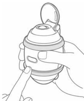
Držite uređaj u okomitom položaju. Upravljajte uređajem zakretanjem kotačića udesno ili ulijevo pri reprodukciji glazbe.
