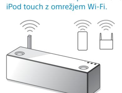
Enoto in napravo iPhone/iPad/iPod touch povežite na isti SSID usmerjevalnika. Navodila za povezavo enote z omrežjem Wi-Fi najdete na drugi strani; prepravi se, da indikator LINK na enoti sveti oranžno.
