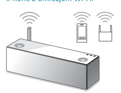
Enoto in pametni telefon/napravo iPhone povežite na isti SSID usmerjevalnika. Navodila za povezavo enote z omrežjem Wi-Fi najdete na drugi strani; prepravi se, da indikator LINK na enoti sveti oranžno.
