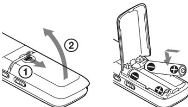
Ako se pokrov baterijskog pretinca slučajno odspoji, pričvrstite ga na način prikazan slikom.
