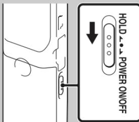
Pomaknite preklopku HOLD•POWER ON/OFF prema sredini.
