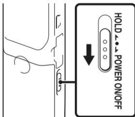
Pomaknite preklopku HOLD•POWER ON/OFF u smjeru "POWER ON/OFF" dulje od jedne sekunde. IC rekorder se uključuje i prikazuje se animacija "Accessing...".
