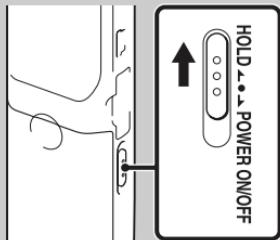
Pomaknite preklopku HOLD•POWER ON/OFF u smjeru "HOLD".
