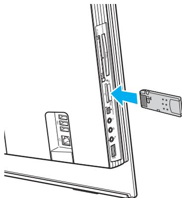
! Tenez le support Memory Stick en orientant correctement la flèche et insérez-le dans l'emplacement prévu à cet effet. Si vous rencontrez une résistance en insérant le support Memory Stick, ne forcez pas afin de ne pas endommager l'ordinateur ou le support.
